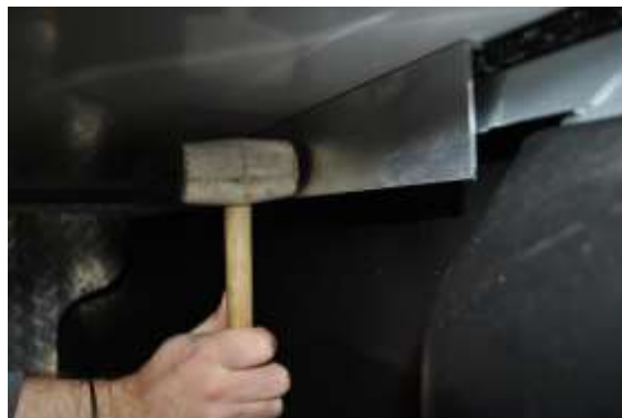
6 Använd hammare för att få vinkeljärnet ligga emot metallisten
