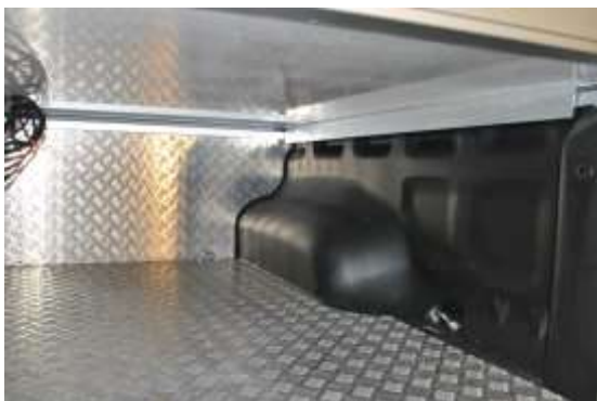
5 Lägga på modulen på vinkeljärnen
