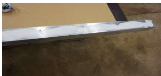
När man förborrat i modulen och allt är klart så stryker man på klistret. Ett jämt lager överallt och sedan popnitar man fast vinkeljärnet i modulen.
