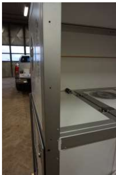
När man förborrat i modulen och allt är klart så stryker man på klistret. Ett jämt lager överallt och sedan popnitar man fast vinkeljärnet i modulen.
