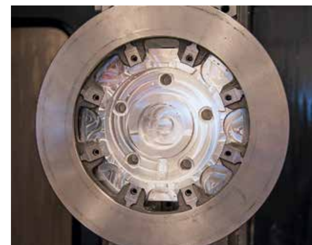
Vi testmonterade även bromsskivan. Per definition: sugpassning.
