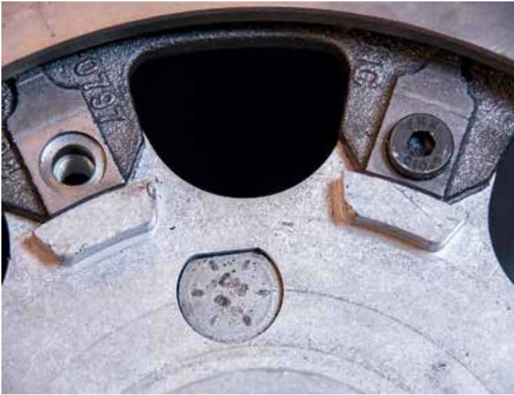
Skivan bultas mot navet med insexskruvar med låg skalle, som synes också försänkta.
