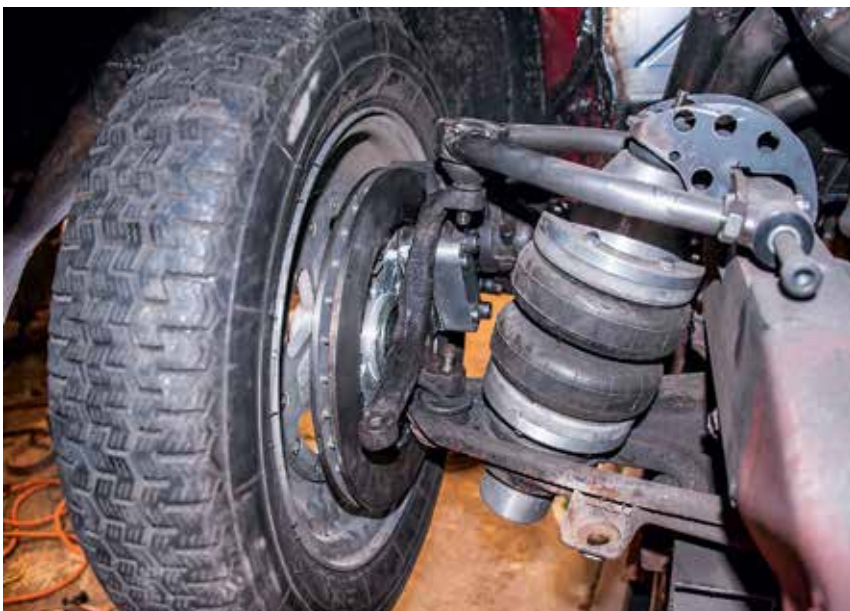
Styrradien mäts i en tänkt linje rakt genom övre och undre kulbult. Från punkten där denna linje når backen bör man i normalfall ha cirka 20-30 millimeter kvar utåt till mitten av däckets.
