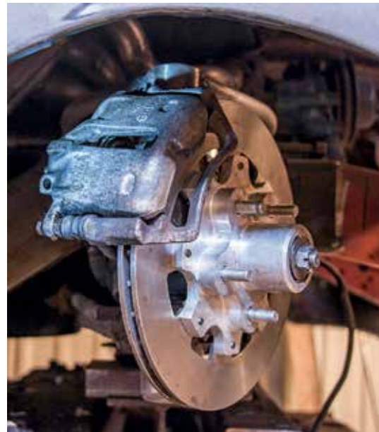
Jämfört med originalmått för Volvo 164 hamnade anliggningsyta 35 millimeter längre in. På så vis kan man nu ha fälgar som breddar rätt mycket utåt utan att få helt galna mått för styrradien.
