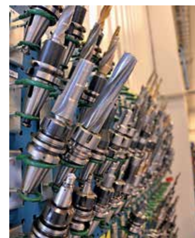
Ska man ha bredd i tillverkningen vill det till att sortimentet med fräsar är därefter. Mazak-maskinen byter själv fräs eller borr efter konstruktion.
