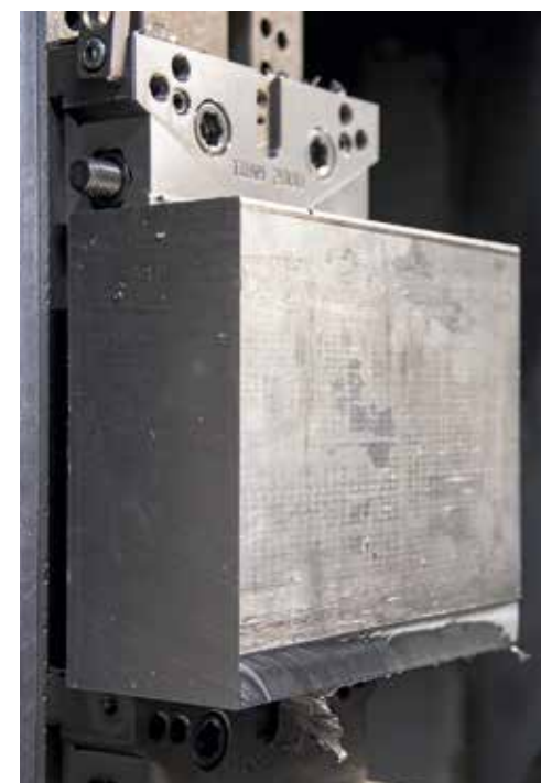
Det utvalda materialet sågas till en rätsidig, lämplig form och bultas på plats i fleroperationsmaskinen.
