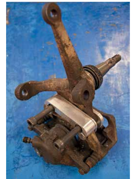
Bromsoket från VW Passat matchades mot 164-spindeln med en adapter i totalt tre delar. Här sattes måtten utifrån ett par huvudsakliga parametrar: dels tänkt offset för bromsskivan och fälgens anläggningsyta, dels de praktiska begränsningarna.
