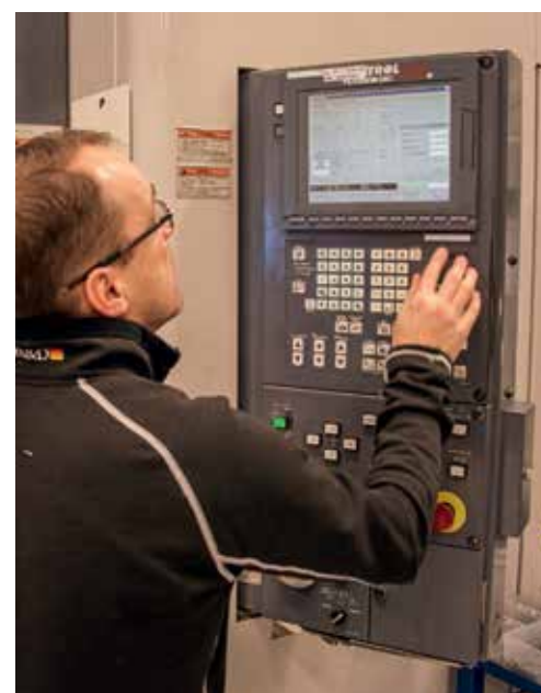
Thomas får styra mätningen manuellt via joystick. För att kunna mäta till exempel omkrets på bromsskivan räcker det att lägga an vid två punkter en bit från varandra, resten räknar Zeiss Conturans dator ut själv.
