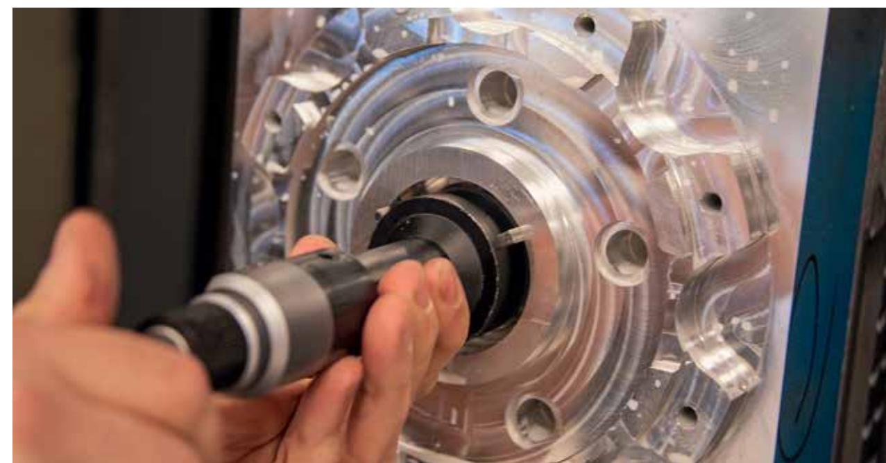
Vi testmonterade även bromsskivan. Per definition: sugpassning.
