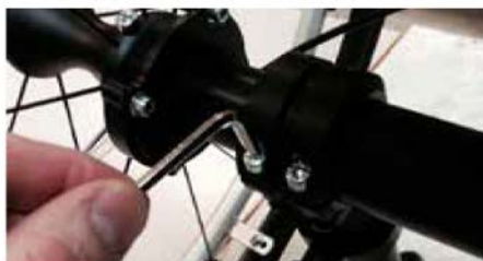
Fig. 10 Justering av hjulbredd
