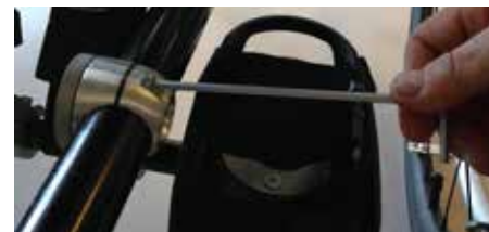
Fig. 02a Höjd på fotplattan justeras med 4 skruvar
