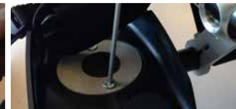
Fig. 02b Bredd, vinkel och rotation av fotplattan justeras med fotplattans 2 skruvar på ovasidan.
