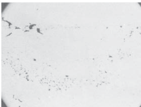
Fig. 1. Översikt över makroetsat längdsnitt av murankare (nr 1) från Gamla Stan i Stockholm.
