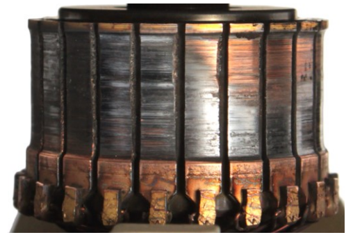
Bilden beskriver en motor med en utsliten kollektor.
