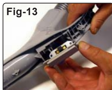
Fig-13. Montera hållaren med strömbrytaren i handtaget. Var noga med att få ner kablarna så dessa inte kan komma i kläm.
