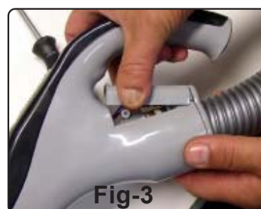
Fig-3. Demontera locket enligt bilden.
