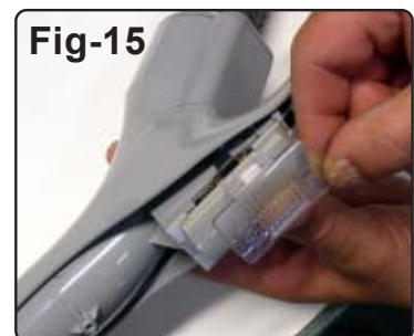
Fig-15. Montera skjutreglaget till strömbrytaren. Även denna kan endast sitta på ett sätt.
