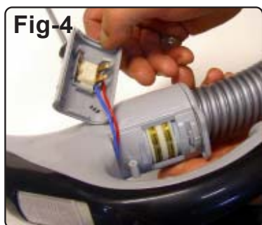
Fig-4. Under locket sitter släpskor som skall ligga an mot kontaktbanorna i slangen. Det är mellan dessa som oxid, damm och smuts kan samlas, vilket kan resultera i kontaktproblem.
