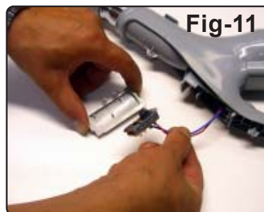
Fig-11. Bilden visar hur strömbrytaren är placerad i hållaren.
