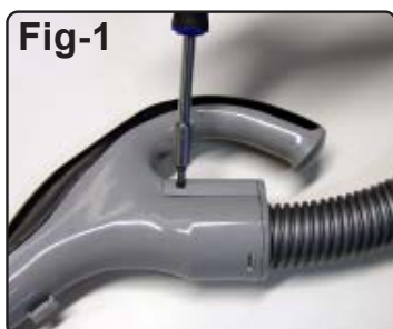
Fig-1. Skruva loss skruven som är placerad på vänster sida om handtaget.
