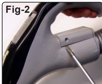
Fig-2. Använd en plan-skruvmejsel och bryt försiktigt upp locket.
