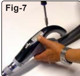
Fig-7. Skruva loss skruvarna som är placerade på var sida om on/off knappen.
