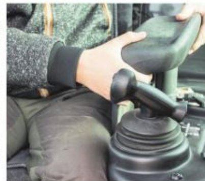
Steglöst ställbara armstöd får höga poäng av testförarna, som har känt i både arbetsmiljön i hytten och körupplevelsen.
