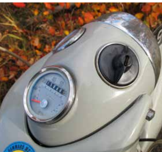
Omkopplaren går inte att vrida utan den speciella nyckel som hör till maskinen
