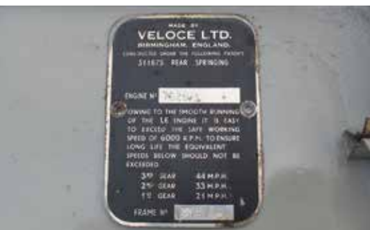
Motorn går så tyst att en varningstext finns på insidan av verktygsåldans lock. Man bör inte varva över 6000 rpm, vilket ger dessa rekommenderade hastigheter på varje växel. Men var tog den fjärde växeln vägen?
