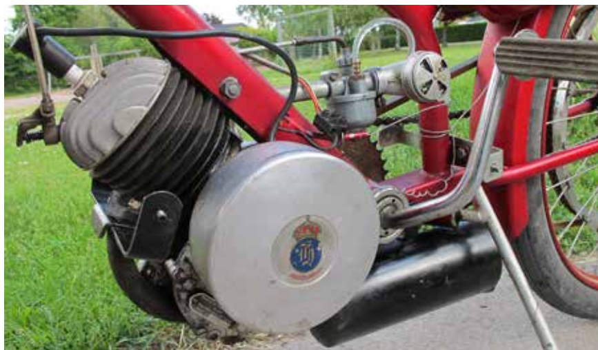
Motorn är monterad mer som en påhängsmotor än som en motor i ramen
