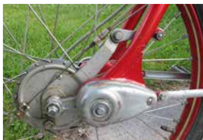
Bottenlänkfjädring genom gummitorsionsfjäder
