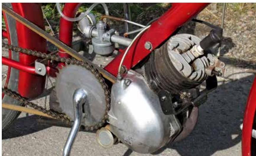
Sitter det en sån här kåpa på motorn så har man lyckan att det finns riktig koppling på den
