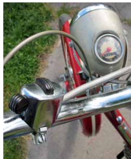
Den trepoliga omkopplaren gjorde huvudströmbrytare på lyktan onödig
