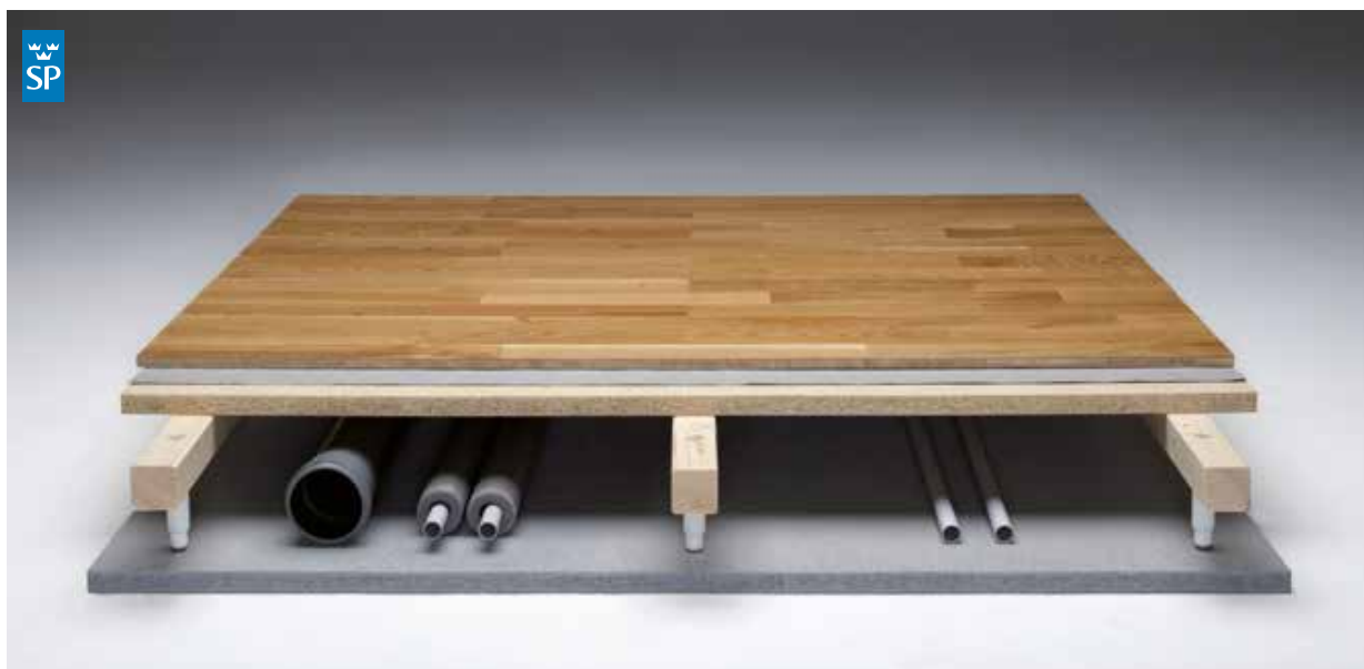
Exempel på golvkonstruktion med 15 mm parkett, P-märkt eller CE-märkt 22–38 mm golvspånskiva i lägst klass P6 som kan skarvas fritt mellan reglar, 45 mm Nivellregel och Nivells plastskruv/akustik.
