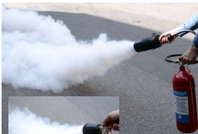
5 kg släckaren har en slang så att släckmedlet enkelt kan spridas över större ytor.
