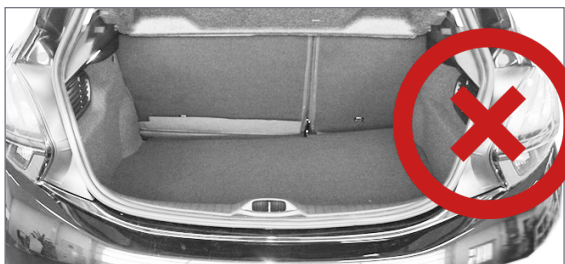
Bagageutrymme med tröskel omöjliggör trucklastning.
