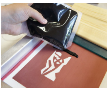
Lägg på en sträng med Screen printing colour och tryck din bildserie på läderhårt eller skråjat gods.
