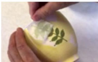
Tryck motivet på Potters-tissue pappret. Klipp ut bilden och lägg den mot godset och gnugga försiktigt till färgen släpper från pappret och fastnar på godset.
