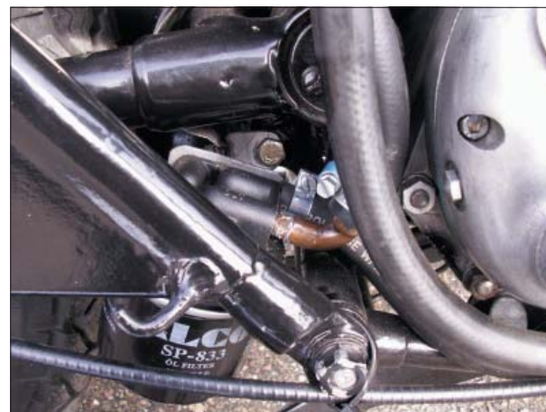
Filter monterat på Matchless G15. Den bortre anslutningen från pumpen, den hitre vidare till tanken.
