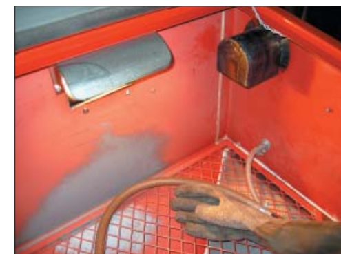
Skärm över belysning och kåpa över utsugsfilter.
