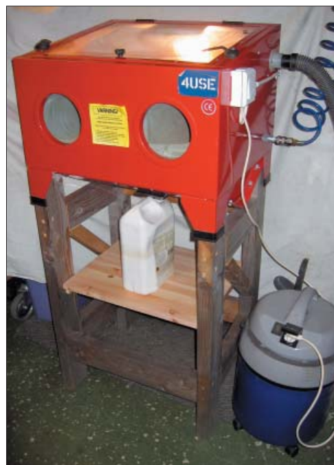
Belysning och grovdammsugare startas/stoppas samtidigt med brytaren (IP55).
