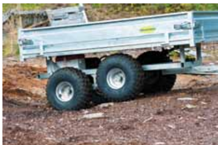
Boggin kan röra sig tillräckligt mycket för att inte hjulen ska gå i luften, utan istället följer marken på ett bra sätt.
