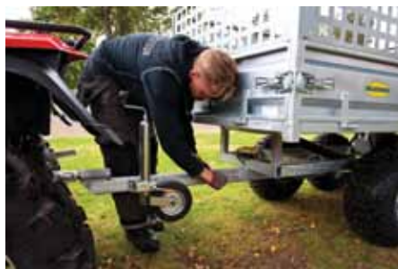
Dragstången har två lägen, där det längre är att föredra när man backar.
