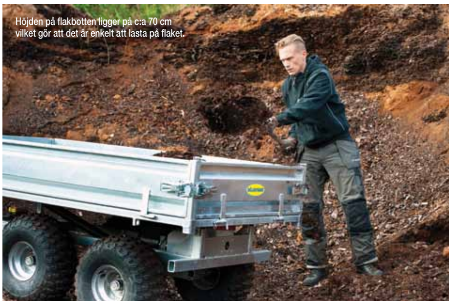
Hydrauliken styrs antingen via fjärr eller med sladd och tippvinkeln är hela 50 grader för att allt ska åka av flaket.
