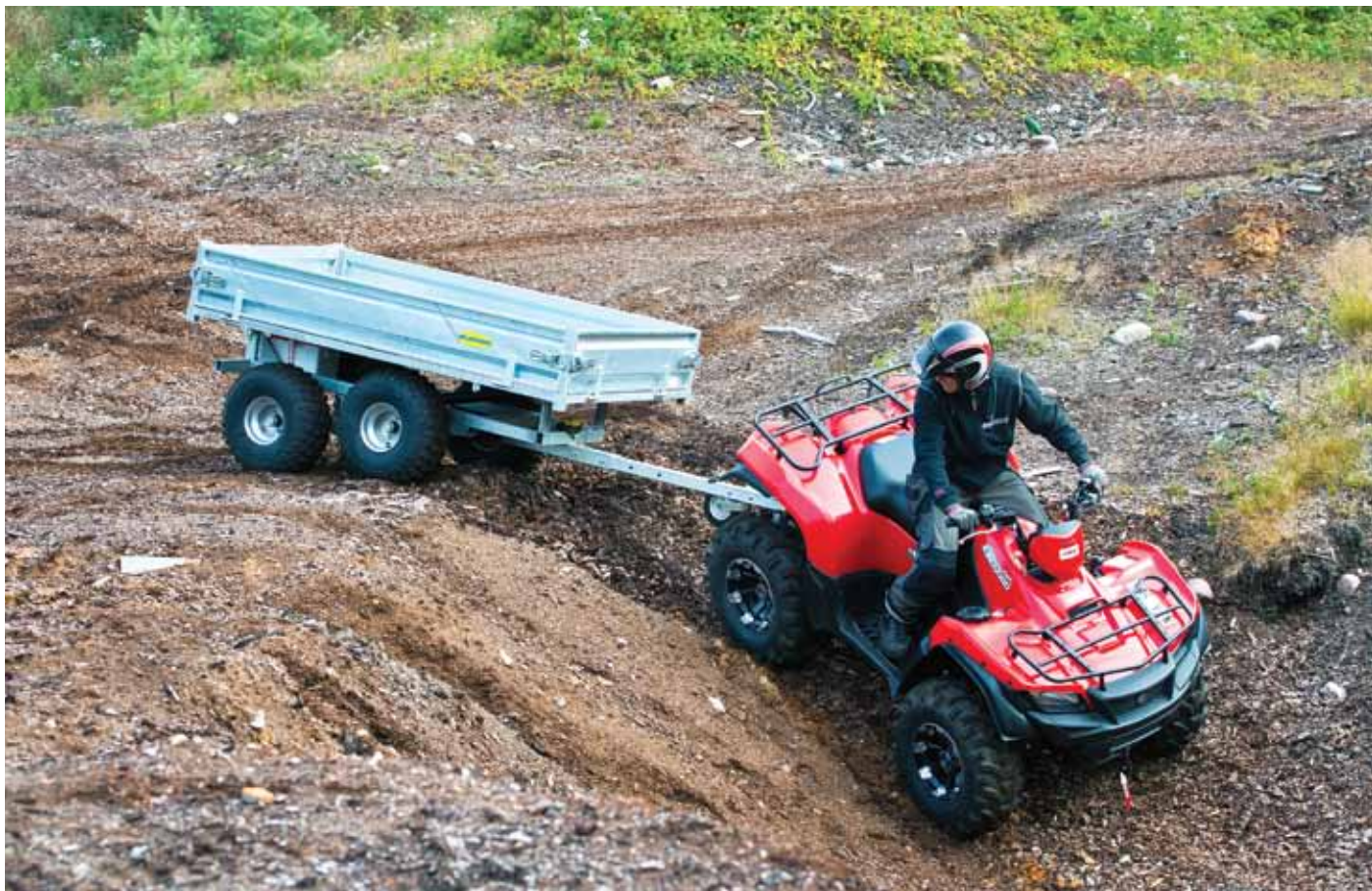
Terrängegenskaperna hos vagnen är utmärkta och boggin följer underlaget mycket bra.
