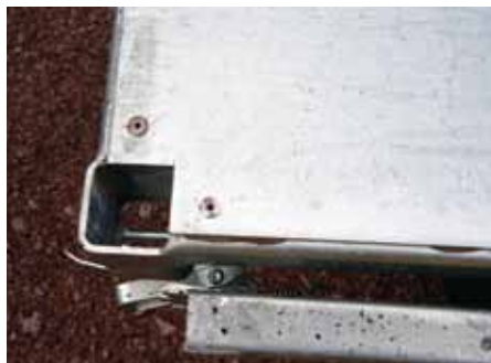
Om man har lastat illa och skadat botten på flaket är det enkelt att byta då det sitter nitat.
