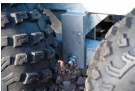
På de flesta ställen använder man sig av bult, allt för att det ska vara enkelt att reparera.
