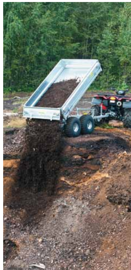
Hydrauliken styrs antingen via fjärr eller med sladd och tippvinkeln är hela 50 grader för att allt ska åka av flaket.
