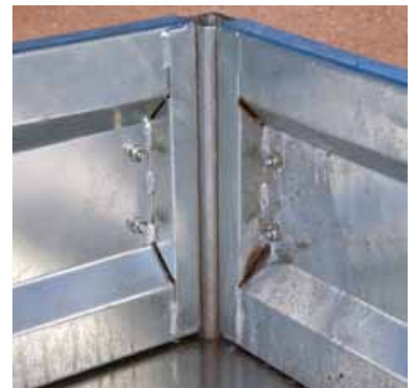
Hos Smålandsvagnen har man även täckt igen hörnen på insidan för att så lite som möjligt ska fastna där.
