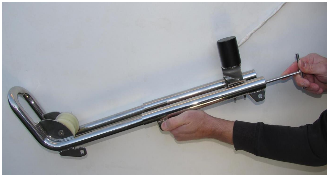
Bild 3: Längdjustering av ankarfällaren.
