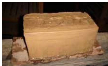
Tegelsten producerad av slime inför bränning.
