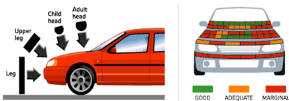
Figur 1: Komponenttester (ben/huvud för barn respektive vuxen) av fordonets fotgängarskydd. Källa: Euro NCap
