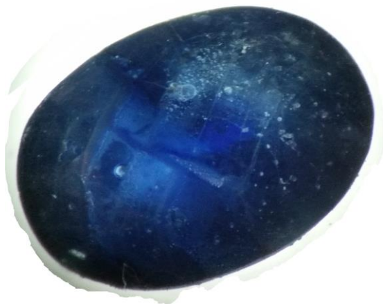
Illustration 7. Glasfylld safir som utsatts för gaslåga vid reparationsarbete. Som synes så smälter glaset och stenen går inte längre att känna igen. Foto Jan Asplund.
