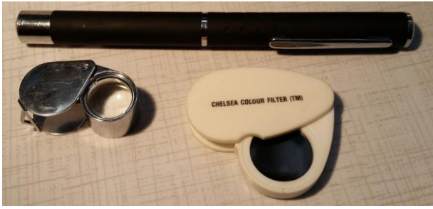
Illustration 3. Lupp med 10x förstoring, laserpenna och/eller ett Chelseafilter är billiga enkla instrument som är lätta att ha med sig och är outhärliga för snabb undersökning om en blå safir kan tänkas vara glasfylld.
