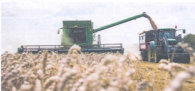
Hos Hilmer på Dalboslätten är tröskningen i full gång. Dagen till ära var en demotröska från John Deere på plats. Modellen är T670i med 9 meters skärbord.
