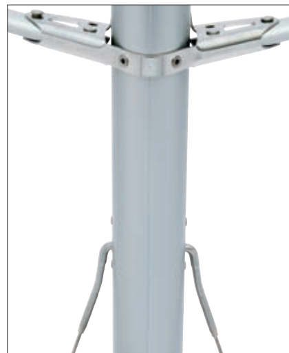
Undervant monterade i hakplåt. C080-C096, CC077-CC095
