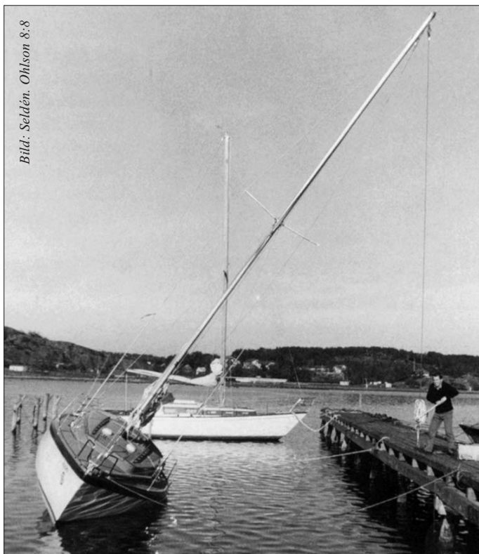
Krängningstest 1971. Båtens rätande moment mäts vid 30° krängning.
