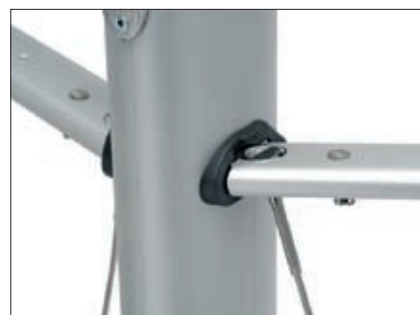
Undervant monterade i genomgående spridarfäste. C106-C139, CC105-CC138
