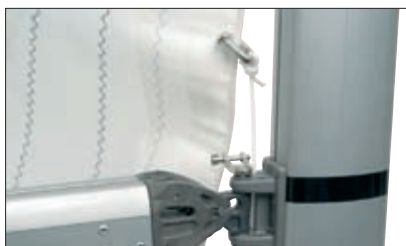
1) Knopa hjälpmataren till bomfästet. Linans längd bestämmer hjälpmatarens position och anpassas efter behov.
