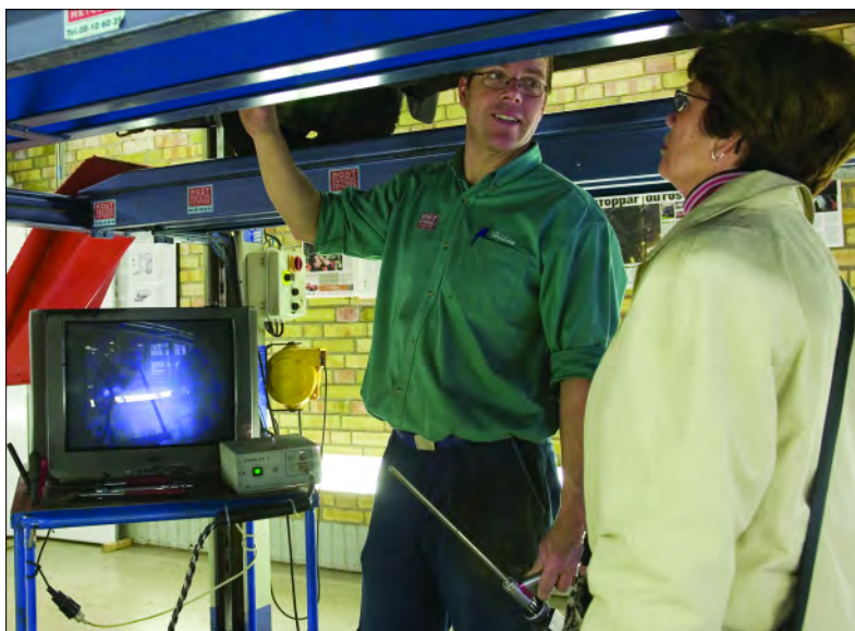
TV-bilden – via fiberoptik och videokamera – ger klart besked om var det finns rost och hur farlig den är. Du kan själv följa kamerans väg när vi testar din bil.
