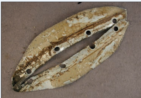
Bakskärm på Volvo 40-serien med god täckning både med ED-lack och rostskyddsmedel.
